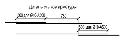
1. Армирование плиты предусмотрено отдельными стержнями. Крестообразные соединения стержней выполнять вязальной проволокой Ø1,5 мм (ГОСТ 73282-74) через одно пересечение в шахматном порядке.
